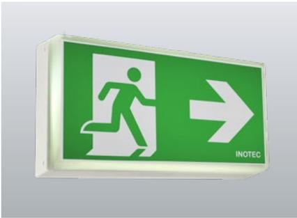
Einseitige Rettungszeichenleuchten aus UV- und glühdrahtbeständigem Polycarbonat mit optionaler seitlicher Kabeleinführung und großzügigem rückseitigem Rangiererraum. Homogene Piktogrammausleuchtung durch optimierte LED-Technik.
