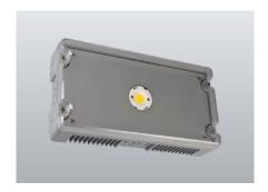
Downlight für erhöhte Beleuchtungsanforderungen. Zur Ausleuchtung von Arbeitsstätten mit besonderer Gefährdung, Schwimmbädern oder Sportstätten. Robustes, chlorbeständiges Gehäuse aus Aluminiumdruckguss mit optionaler seitlicher Kabelverschraubung. Mit Timerfunktion im DC Betrieb zur Reduzierung der Batteriekapazität. Ideal geeignet gem. EN 12193.
