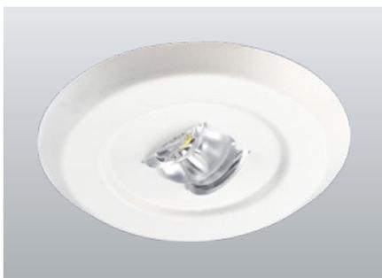
LED-Sicherheitsleuchte mit optimierter Lichtverteilung zur Ausleuchtung von Rettungswegen mit großen Lichtpunkthöhen. Ebenfalls geeignet zur Beleuchtung von Brandbekämpfungs- und Meldeeinrichtungen sowie Erste-Hilfe-Stellen mit 5lx vertikaler Beleuchtungsstärke. Gehäuse aus pulverbeschichtetem Aluminium zum Einbau in Ø 68mm Deckenausschnitt. Inkl. 4-Chip LED-Leuchtmittel für maximale Sicherheit.
