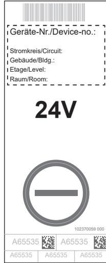
Zur Kennzeichnung der Leuchte, Zuordnung im Stromkreis/-plan und der weiteren Dokumentation wird ein Kennzeichnungsaufkleber mitgeliefert. Diesem sind mehrere Aufkleber und Daten zu entnehmen. Mit der INOConfig-App kann die individuelle ID-Nummer über den QR-Code oder Barcode eingescannt werden.
