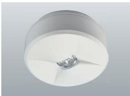
LED-Sicherheitsleuchte mit optimierter Lichtverteilung zur Ausleuchtung von Rettungswegen mit großen Lichtpunkthöhen. Ebenfalls geeignet zur Beleuchtung von Brandbekämpfungs- und Meldeeinrichtungen sowie Erste-Hilfe-Stellen mit 5lx vertikaler Beleuchtungsstärke. Gehäuse aus pulverbeschichtetem Aluminium zur Deckenaufbaumontage mit optionaler seitlicher Kabeleinführung. Inkl. 4-Chip LED-Leuchtmittel für maximale Sicherheit.
