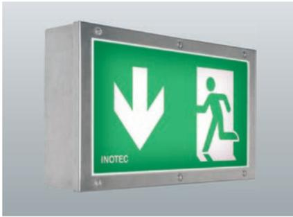
Einseitige Rettungszeichenleuchten aus robustem, gebürstetem Edelstahl mit hoher Schutzart. Homogene Piktogrammausleuchtung durch optimierte LED-Technik mit einer Leuchtdichte > 500 cd/m<sup>2</sup>. Zum Einsatz in Lebensmittelbereichen bzw. lebensmittelverarbeitenden Betrieben mit hohen Anforderungen an Produkthygiene geeignet. Optional mit Piktogramm aus Makrolon für erhöhte Schlagfestigkeit IK10+ (50 Joule).
