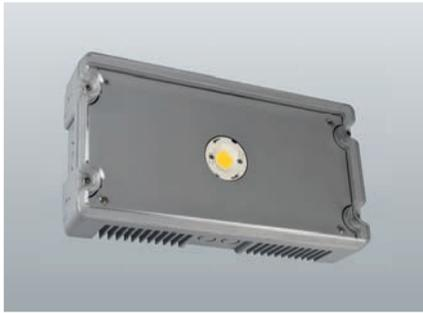
Downlight für erhöhte Beleuchtungsanforderungen. Zur Ausleuchtung von Arbeitsstätten mit besonderer Gefährdung, Schwimmbädern oder Sportstätten. Robustes, chlorbeständiges Gehäuse aus Aluminiumdruckguss mit optionaler seitlicher Kabelverschraubung. Mit Timerfunktion im DC Betrieb zur Reduzierung der Batteriekapazität. Ideal geeignet gem. EN 12193.
