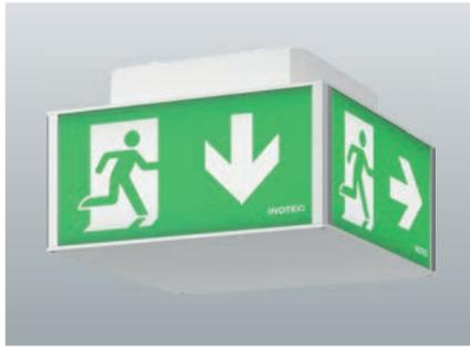
Vierendeckige Rettungszeichenleuchte mit eloxiertem Aluminium-Eckprofil und vielseitig einsetzbarem Anschlusskasten aus weißem UV- und glühdrahtbeständigem Polycarbonat mit optionaler seitlicher Kabeleinführung. Homogene Piktogrammausleuchtung durch optimierte LED-Technik mit einer Leuchtdichte > 500 cd/m<sup>2</sup> und je Leuchtenseite einzeln auswechselbaren Piktogrammen.
