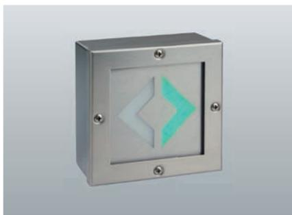
Dynamische Fluchtwegsegmentleuchte mit Laufflichtfunktion und hoher Schutzart aus Edelstahl zur Anzeige des sicheren Fluchtweges in Abhängigkeit der Rauchausbreitung eines Brandes. Spannungsversorgung über PSU 48.
