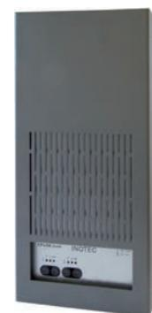
Mikroprozessorgesteuerte, modulare Ladestufe für 230V Zentralbatteriegerät mit max. 3A Ladestrom in 19"-Gehäuse. Ladung erfolgt nach Kennlinie I/U gem. DIN EN 50272-1.
