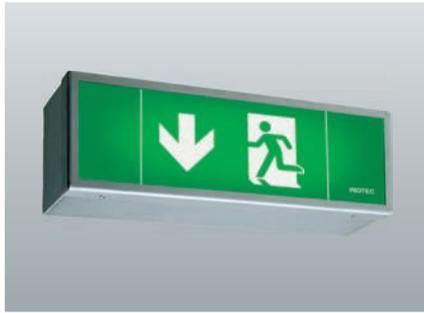
Einseitige Rettungszeichenleuchten aus robustem, gebürstetem Edelstahl mit hoher Schutzart. Homogene Piktogrammausleuchtung durch optimierte LED-Technik mit einer Leuchtdichte  $> 500 \text{ cd/m}^2$ . Zum Einsatz in Lebensmittelbereichen bzw. lebensmittelverarbeitenden Betrieben mit hohen Anforderungen an Produkthygiene geeignet.
