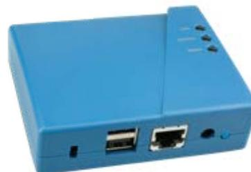
INOView ZLT-Interface zur Weiterleitung von Störmeldungen an die vorhandene GLT. Zum Anschluss von einem Fernschalter sowie zur Schleifenüberwachung geeignet. Fünf potentialfreie Meldekontakte für Betrieb, Batteriebetrieb, Störung(Allgemein) und 2x frei programmierbar.
