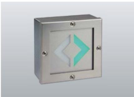
Dynamische Fluchtwegsegmentleuchte mit Lauflichtfunktion und hoher Schutzart aus Edelstahl zur Anzeige des sicheren Fluchtweges in Abhängigkeit der Rauchausbreitung eines Brandes. Spannungsversorgung über PSU 48.
