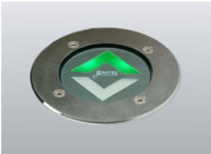
Dynamische Rettungswegsegmentleuchte für Bodeneinbaumontage zur Anzeige des sicheren Rettungsweges mittels Lauflichtfunktion in Abhängigkeit der Rauchausbreitung eines Brandes. Spannungsversorgung über PSU 48.
