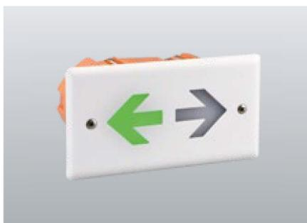
Wandeinbauleuchte für bodennahe Montage zur dynamischen Anzeige des sicheren Fluchtweges in Abhängigkeit der Rauchausbreitung eines Brandes. Leuchte mit pulverbeschichteter Metallblende zur Montage in Doppeldose für Beton (Kaiser 1269-40), Hohlwand (Kaiser 9062-94), Brandschutz (Kaiser 9462-94) oder Unterputz (Kaiser 1656-21).
