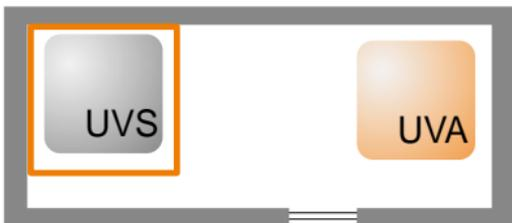
die Verteiler mit Bauteilen umgeben werden, die eine Feuerwiderstandsdauer entsprechend der Dauer des Funktionserhaltes haben, wobei die Funktion der elektrischen Einbauten für die Dauer des Funktionserhaltes gewährleistet sein muss.
