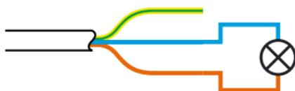
Jeder Stromkreis ist in einem separaten Kabel / einer separaten Leitung zu führen.
