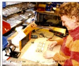
Die LED-Leuchten werden an diesem Stand in die vorgefertigten Fassungen gepresst.
