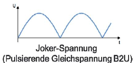
Die "Joker-Spannung" steht an den Betriebsgeräten bei einem lokalen Spannungsausfall (Netzausfall UV) und noch anstehender Netzspannung an der Zentralbatterieanlage an. Die Spannungsform kann zeitlich unbegrenzt anstehen.
