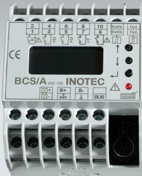
INOTEC Battery-Control-System zur Überwachung und Protokollierung der Blockspannung und –temperatur von jedem einzelnen Batterieblock. Ermöglicht die frühzeitige Erkennung und Meldung defekter Batterieblöcke. Automatische Abschaltung der Ladung und Unterbrechung des Betriebsdauertests bei Batterieblockstörungen zum Schutz vor Zerstörung der gesamten Batterie.
