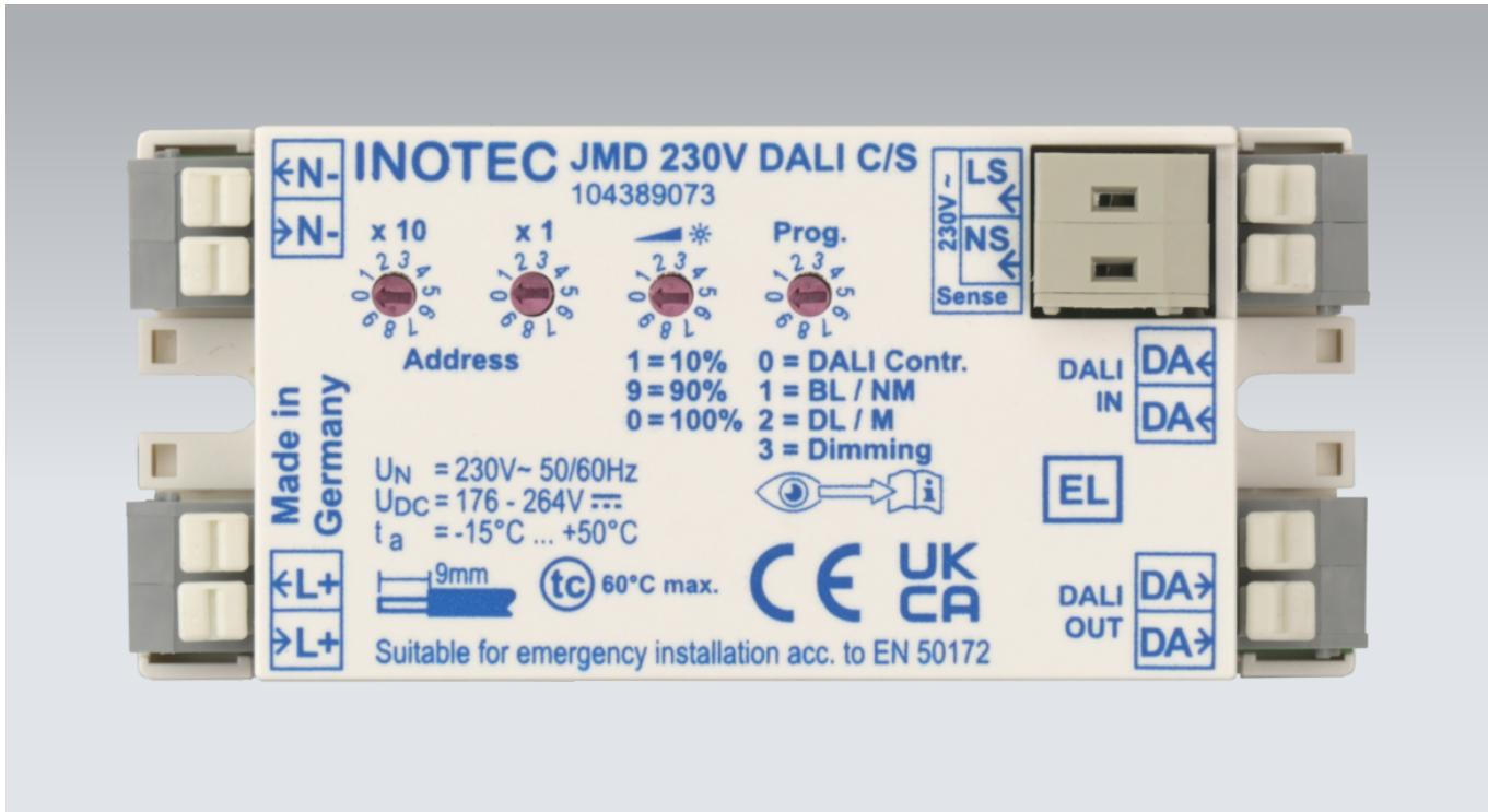
Überwachungsmodul zur Einzelüberwachung von Leuchten mit integrierten DALI-Betriebsgeräten mit einer maximalen Last von 300W. Zum Anschluss an INOTEC Zentralbatterieanlagen mit Joker Technik (J/SV). Mit integriertem 230V Schalteingang für geschaltetes Dauerlicht oder für eine lokale Phasenwächterfunktion zur Überwachung der Allgemeinbeleuchtung.
