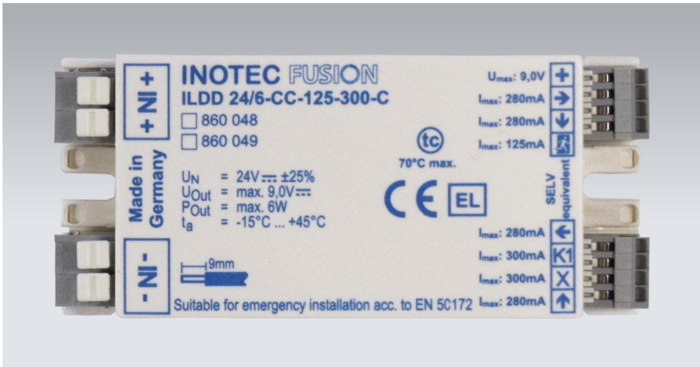
Mehrkanaliger LED-Betriebsgerät mit integrierter Einzel-LED-Überwachung zur Erkennung einzelner defekter LEDs bei Kurzschluss oder Unterbrechung für jeden LED-Ausgang. Frei programmierbare Schaltzuweisungen für bis zu 8 Schaltzuweisungen je LED-Ausgang ohne separate Busleitung über das Steuerteil der Anlage. Jeder LED-Ausgang kann einzeln geschaltet oder gedimmt werden sowie für eine Blinkfunktion programmiert werden.
