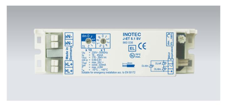
LED-Betriebsgerät mit integrierter Einzelleuchtenüberwachung und frei programmierbarer Schaltungsart für Bereitschaftslicht (BL) und Dauerlicht (DL) ohne separate Busleitung. Hohe Funktionssicherheit durch Einhaltung internationaler Standards zur Sicherheit und Arbeitsweise, elektromagnetische Verträglichkeit und Störsicherheit. LED-Ausgang stufenlos dimmbar im Netzbetrieb. Zum Anschluss an JOKER-Zentralbatterieanlagen.
