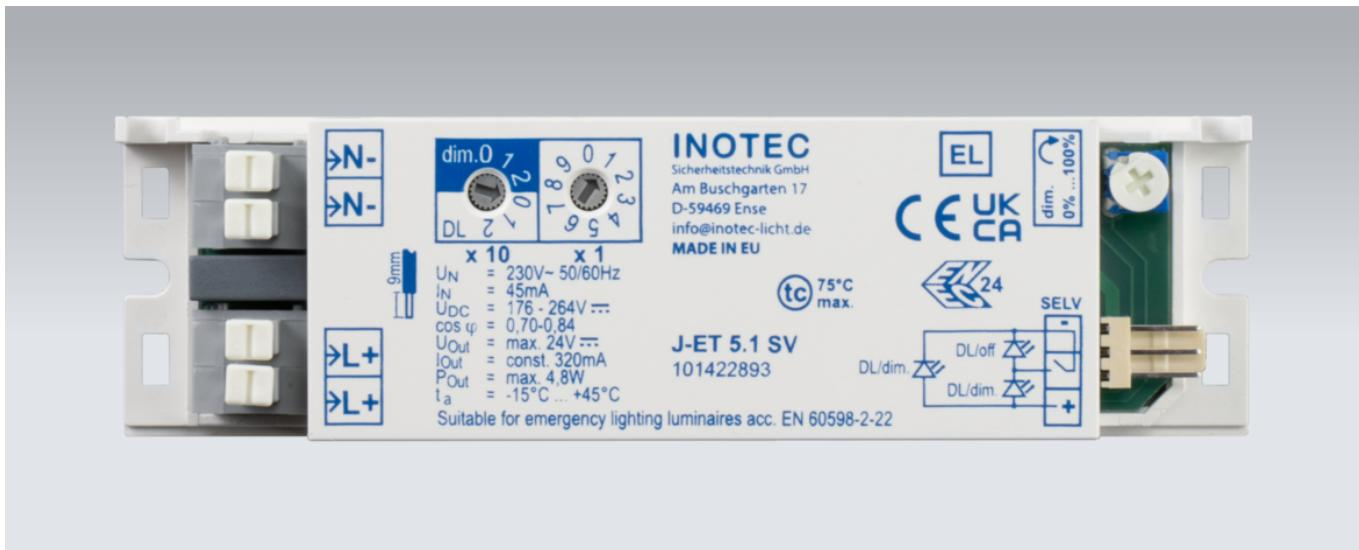
LED-Betriebsgerät mit integrierter Einzelleuchtenüberwachung und frei programmierbarer Schaltungsart für Bereitschaftslicht (BL) und Dauerlicht (DL) ohne separate Busleitung. Hohe Funktionssicherheit durch Einhaltung internationaler Standards zur Sicherheit und Arbeitsweise, elektromagnetische Verträglichkeit und Störsicherheit. LED-Ausgang stufenlos dimmbar im Netzbetrieb. Zum Anschluss an JOKER-Zentralbatterieanlagen.
