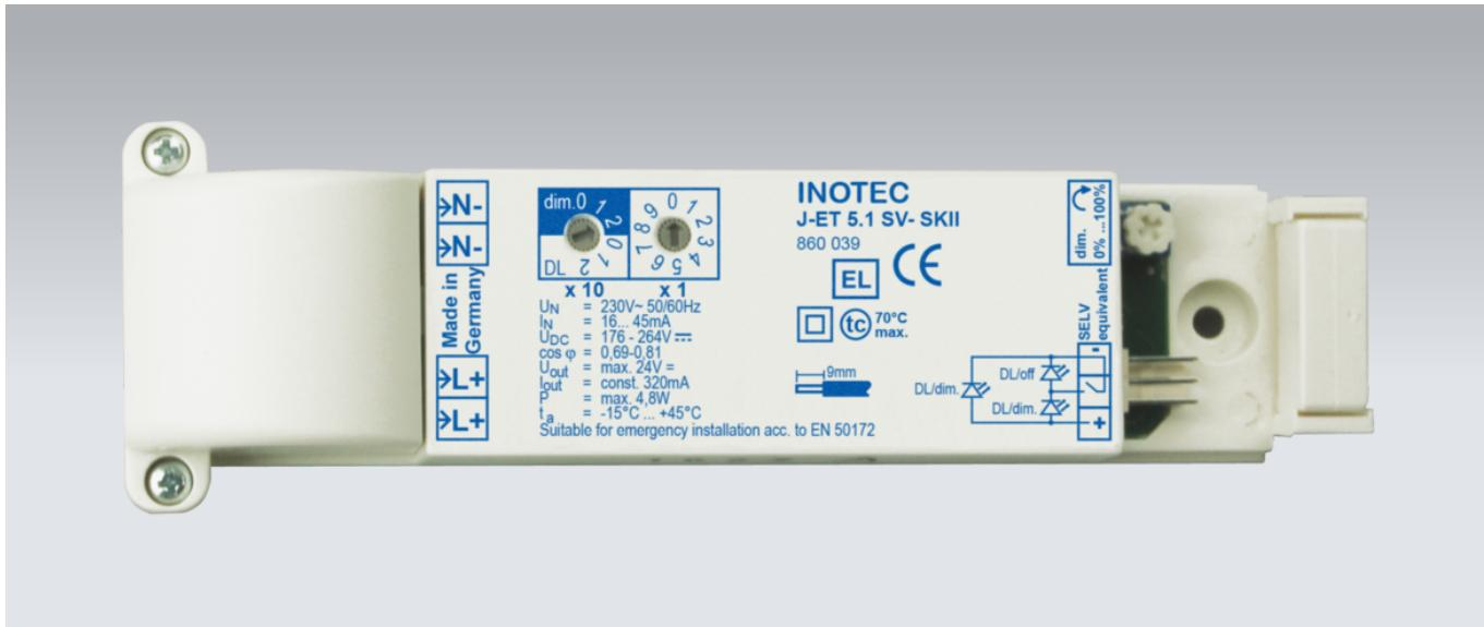
LED-Betriebsgerät mit integrierter Einzelleuchtenüberwachung und frei programmierbarer Schaltungsart für Bereitschaftslicht (BL) und Dauerlicht (DL) ohne separate Busleitung. Hohe Funktionssicherheit durch Einhaltung internationaler Standards zur Sicherheit und Arbeitsweise, elektromagnetische Verträglichkeit und Störsicherheit. LED-Ausgang stufenlos dimmbar im Netzbetrieb. Zum Anschluss an JOKER-Zentralbatterieanlagen.
