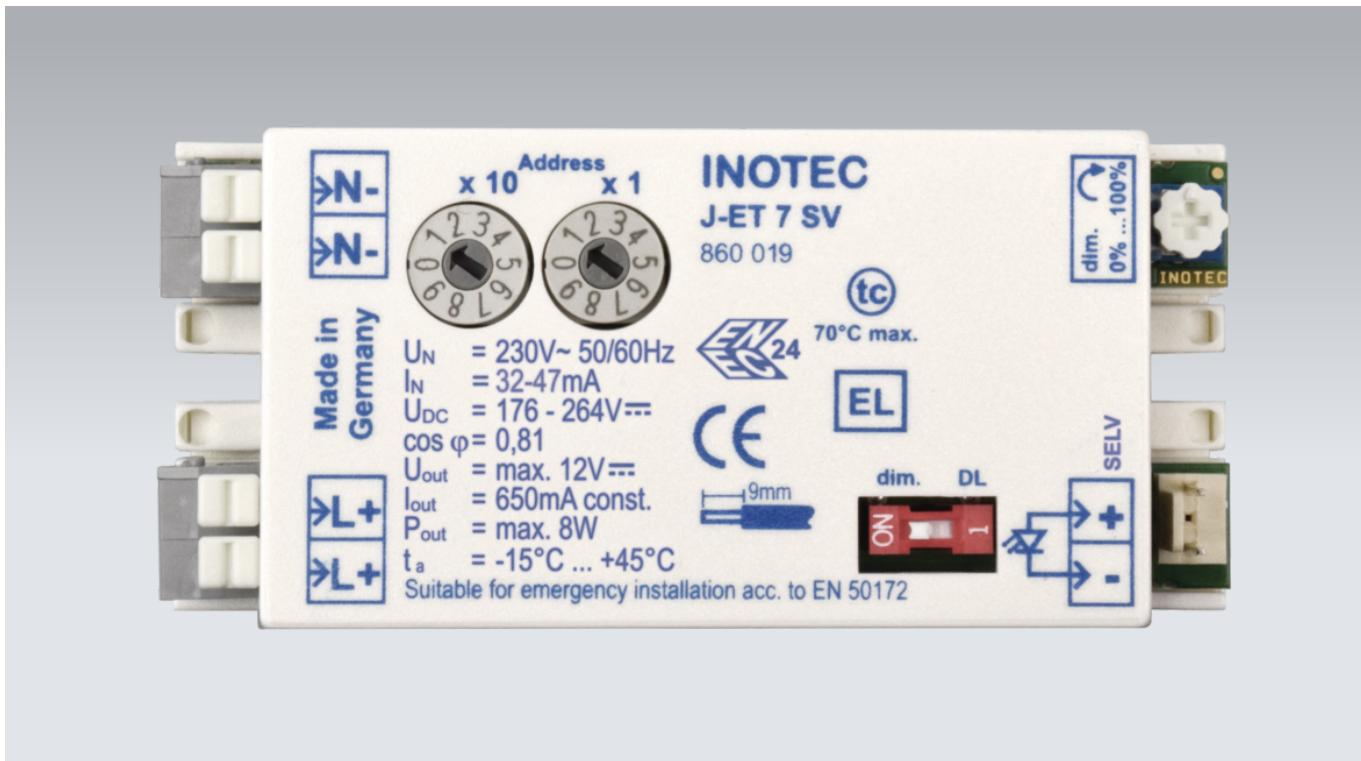
LED-Betriebsgerät mit integrierter Einzelleuchtenüberwachung und frei programmierbarer Schaltungsart für Bereitschaftslicht (BL) und Dauerlicht (DL) ohne separate Busleitung. Hohe Funktionssicherheit durch Einhaltung internationaler Standards zur Sicherheit und Arbeitsweise, elektromagnetische Verträglichkeit und Störsicherheit. LED-Ausgang stufenlos dimmbar im Netzbetrieb. Zum Anschluss an JOKER-Zentralbatterieanlagen.
