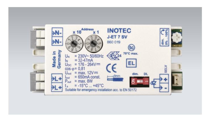
LED-Betriebsgerät mit integrierter Einzelleuchtenüberwachung und frei programmierbarer Schaltungsart für Bereitschaftslicht (BL) und Dauerlicht (DL) ohne separate Busleitung. Hohe Funktionssicherheit durch Einhaltung internationaler Standards zur Sicherheit und Arbeitsweise, elektromagnetische Verträglichkeit und Störsicherheit. LED-Ausgang stufenlos dimmbar im Netzbetrieb. Zum Anschluss an JOKER-Zentralbatterieanlagen.
