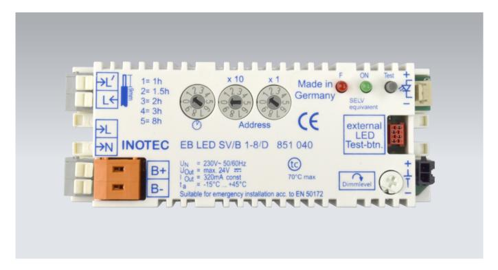
LED-Betriebsgerät mit integrierter Einzelleuchtenüberwachung für Bereitschaftslicht (BL), Dauerlicht (DL) und geschaltetem Dauerlicht (gDL). Mit integrierter Ladetechnik und frei wählbarer Nennbetriebsdauer von 1h, 1,5h, 2h, 3h oder 8h mit INOTEC SV/B - Funktionskontrolle zum Anschluss an eine zentrale Überwachungseinrichtung BNS-MTB gem. DIN EN 50172, DIN VDE 0100-718 und DIN VDE V 0108-100-1.
