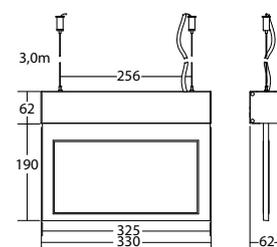
Wand- oder Deckenmontage    Lichtfarbe: 6500 K    Schutzart: IP40
