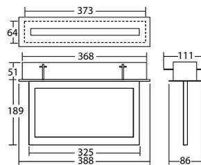
Pendelmontage    Lichtfarbe: 6500 K    Schutzart: IP40
