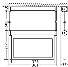
Seilmontage Lichtfarbe: 6500 K Schutzart: IP20
