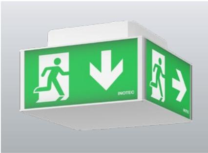
Vierseitige Rettungszeichenleuchte mit eloxiertem Aluminium-Eckprofil und vielseitig einsetzbarem Anschlusskasten aus weißem UV- und glühdrabtbeständigem Polycarbonat mit optionaler seitlicher Kabeleinführung. Homogene Piktogrammausleuchtung durch optimierte LED-Technik mit einer Leuchtdichte > 500 cd/m<sup>2</sup> und je Leuchtenseite einzeln auswechselbaren Piktogrammen.
