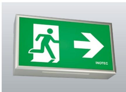
Einseitige Rettungszeichenleuchten aus Aluminiumprofil mit Lichtaustritt nach unten. Homogene Piktogrammausleuchtung durch optimierte LED-Technik mit einer Leuchtdichte > 500 cd/m<sup>2</sup>.
