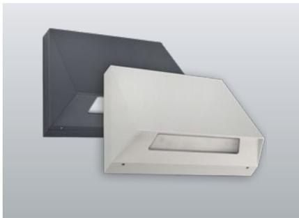
Sicherheitsleuchte mit gerichtetem Licht ohne Lichtstromanteil im oberen Halbraum. Robustes trapezförmiges Leuchtengehäuse für Wandmontage aus pulverbeschichtetem Aluminiumdruckguss. Hohe Schutzart zur Montage im Außenbereich. Und optionaler seitlicher Kabeleinführung. Durch ausgelagerter Versorgungseinheit für den Einsatz im Außenbereich geeignet.
