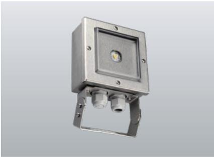
Robuste LED-Sicherheitsleuchte mit optimierter Lichtverteilung zur Ausleuchtung von Flächen. Leuchte aus gebürstetem Edelstahl mit hoher Schutzart. Selbstüberwachende LED Einzelbatterieleuchte inkl. hochwertiger NiMH-Hochtemperaturzelle. Durch ausgelagerter Versorgungseinheit für den Einsatz im Außenbereich geeignet. Externe Versorgungseinheit: IP66; Ta: -5...+40 °C
