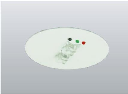
Dezente LED- Sicherheitsleuchten optimiert zur Ausleuchtung von Rettungswegen. Leuchten für Deckeneinbaumontage mit pulverbeschichteter Metallblende ohne sichtbare Schrauben. Werkzeuglose Montage in Ø 68mm Deckenausschnitt.
