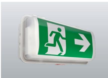
Explosionengeschützte Sicherheits- und Rettungszeichenleuchten für Zone 1, 2, 21, 22. Leuchten für Decken- bzw. Wandaufbaumontage aus hochwertigem glasfaserverstärktem Polyesterharz.
