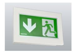
Multifunktionale dynamische TFT-Piktogrammleuchte aus UV- und glühdrahtbeständigem Polycarbonat. Zur richtungsvariablen Anzeige des sicheren Fluchtweges und Sperrung betroffener Bereiche in Abhängigkeit der Rauchausbreitung eines Brandes sowie Anzeige diverser Sicherheitszeichen oder kundenspezifischer Piktogramme. Durch das eingesetzte TFT, inkl. Backlight- und Bildinhaltüberwachung werden die Piktogramme normkonform angezeigt und können einfach ausgetauscht werden.
