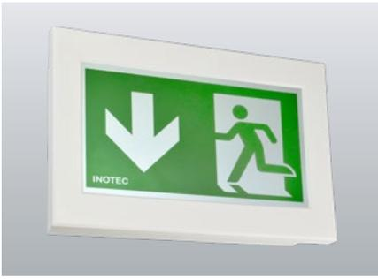
Multifunktionale dynamische TFT-Piktogrammeleuchte aus UV- und glühdrahtbeständigem Polycarbonat. Zur richtungsvariablen Anzeige des sicheren Fluchtweges und Sperrung betroffener Bereiche in Abhängigkeit der Rauchausbreitung eines Brandes sowie Anzeige diverser Sicherheitszeichen oder kundenspezifischer Piktogramme. Durch das eingesetzte TFT, inkl. Backlight- und Bildinhaltüberwachung werden die Piktogramme normkonform angezeigt und können einfach ausgetauscht werden.
