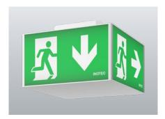
Lampada di sicurezza di forma cubica (4 facce) per segnalazione vie di fuga con profilo angolare in alluminio anodizzato e corpo in policarbonato di colore bianco resistente ai raggi UV testato al filo incandescente. Illuminamento omogeneo grazie all'avanzata tecnologia LED con luminanza di almeno; 500 cd / m², pittogrammi personalizzabili per ciascun lato.
