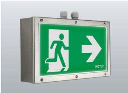
Lampada di sicurezza monofacciale per segnalazione vie di fuga costruita in robusto acciaio inox spazzolato con grado di protezione elevato. Illuminamento omogeneo grazie all'avanzata tecnologia LED con luminanza di almeno 500 cd/m<sup>2</sup>. Adatta all'uso nell'industria alimentare o negli impianti di trasformazione alimentare di prodotti con elevati requisiti di igiene.
