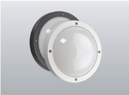
Lampada a LED per l'utilizzo combinato come illuminazione di sicurezza e ordinaria per installazione in ambiente esterno. Corpo in pressofusione di alluminio con verniciatura a polvere resistente agli agenti atmosferici, grado di protezione IP65, resistenza agli urti IK10.
