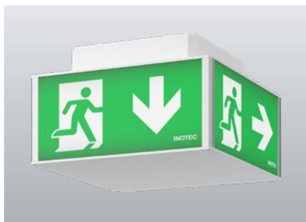
Lampada di sicurezza di forma cubica (4 facce) per segnalazione vie di fuga con profilo angolare in alluminio anodizzato e corpo in policarbonato di colore bianco resistente ai raggi UV testato al filo incandescente. Illuminamento omogeneo grazie all'avanzata tecnologia LED con luminanza di almeno;  $500 \text{ cd} / \text{m}^2$ , pittogrammi personalizzabili per ciascun lato.
