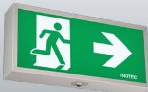
Lampada di sicurezza monofacciale per segnalazione vie di fuga costruita in profilato di alluminio di elevata qualità, design sottile, illuminamento omogeneo grazie all'avanzata tecnologia LED. Installazione semplice e flessibile grazie alla possibilità di ingresso cavi laterale e posteriore. Completa di INOTEC Spot-Light 2 per l'illuminazione di zone da evidenziare tipo presidi antincendio.
