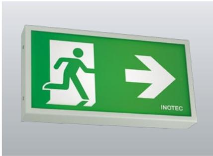
Lampada di sicurezza monofacciale per segnalazione vie di fuga resistente agli urti e protetta contro i colpi di pallone. Corpo in alluminio verniciato a polvere; illuminamento omogeneo grazie all'avanzata tecnologia LED con luminanza di almeno 500 cd/m<sup>2</sup>. Idonea per l'uso in ambienti con forti sollecitazioni meccaniche e in impianti ad uso sportivo.
