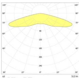
Montaggio a soffitto: Illum. min. 1.0lx (linea centrale della via di fuga), Fatt. di manutenzione 0,8.
