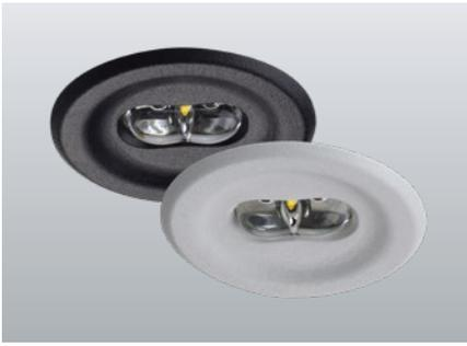
Discreto Lampada di sicurezza a LED con distribuzione della luce ottimizzata per l'illuminazione di vie di fuga. Corpo in pressofusione di alluminio verniciato a polvere Ø45mm. per installazione in controsoffitto. Driver di alimentazione incluso per foro in controsoffitto Ø38mm.
