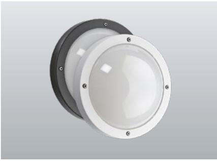
LED-Außenleuchte für Sicherheits- und/ oder Allgemeinlicht. Robustes Gehäuse aus Aluminiumdruckguss mit wetterfester Pulverbeschichtung, hoher Schutzart IP65 und Schlagfestigkeit IK10.
