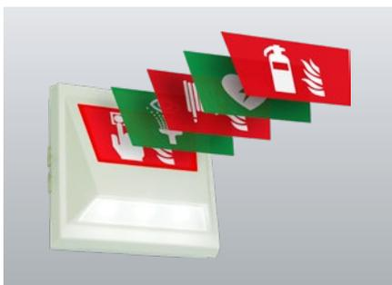
Vielseitige LED-Sicherheitsleuchten zur Ausleuchtung von hervorzuhebenden Stellen gem. DIN EN 1838 und separat schaltbarem, hinterleuchtetem Sicherheitszeichen. Leuchten für Wandaufbaumontage aus UV- und glühdrahtbeständigem Polycarbonat und optionaler seitlicher Kabeleinführung.
