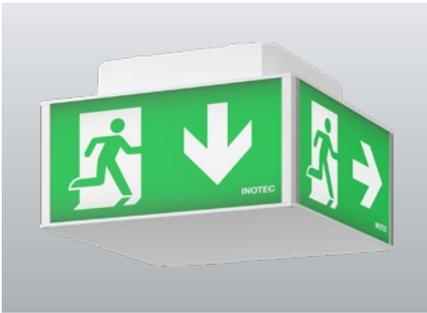
Vierendeckige Rettungszeichenleuchte mit eloxiertem Aluminium-Eckprofil und vielseitig einsetzbarem Anschlusskasten aus weißem UV- und glühdrabtbeständigem Polycarbonat mit optionaler seitlicher Kabeleinführung. Homogene Piktogrammausleuchtung durch optimierte LED-Technik mit einer Leuchtdichte > 500 cd/m<sup>2</sup> und je Leuchtenseite einzeln auswechselbaren Piktogrammen.
