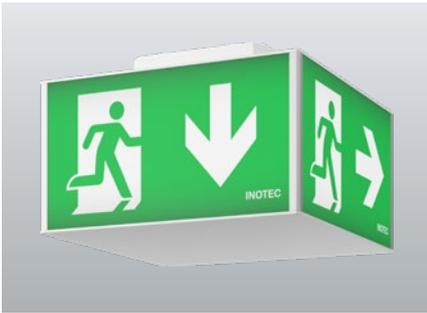
Vierseitige Rettungszeichenleuchte mit eloxiertem Aluminium-Eckprofil und vielseitig einsetzbarem Anschlusskasten aus weißem UV- und glühdrahtbeständigem Polycarbonat mit optionaler seitlicher Kabeleinführung. Homogene Piktogrammausleuchtung durch optimierte LED-Technik mit einer Leuchtdichte > 500 cd/m<sup>2</sup> und je Leuchtenseite einzeln auswechselbaren Piktogrammen.
