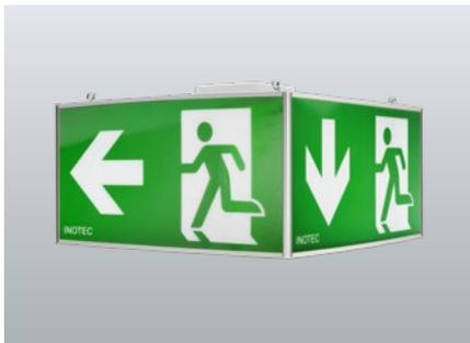
Vierseitige Rettungszeichenleuchte mit großer Erkennungsweite und eloxiertem Aluminium-Eckprofil. Leuchtenkorpus mit Piktogrammen vorbereitet für abgehängte Deckenmontage mit von oben eingesetztem Leuchteinsatz. Homogene Piktogrammausleuchtung durch optimierte LED-Technik und je Leuchtenseite einzeln auswechselbaren Piktogrammen.
