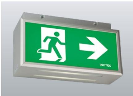
Zweiseitige Rettungszeichenleuchten aus Aluminiumprofil mit Lichtaustritt nach unten. Homogene Piktogramausleuchtung durch optimierte LED-Technik mit einer Leuchtdichte > 500 cd/m<sup>2</sup>.
