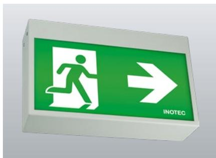
Zweiseitige Rettungszeichenleuchten mit ballwurfsicherem und schlagfestem Gehäuse aus pulverbeschichtetem Metall. Homogene Piktogrammausleuchtung durch optimierte LED-Technik mit einer Leuchtdichte > 500 cd/m<sup>2</sup>. Leuchten in flacher Bauform zum Einsatz in Umgebungen mit erhöhten mechanischen Beanspruchungen und in Sportstätten.
