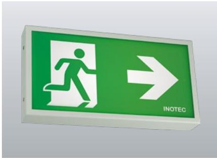
Einseitige Rettungszeichenleuchten mit ballwurfsicherem und schlagfestem Gehäuse aus pulverbeschichtetem Metall. Homogene PiktoGRAMM-ausleuchtung durch optimierte LED-Technik mit einer Leuchtdichte > 500 cd/m<sup>2</sup>. Leuchten in flacher Bauform zum Einsatz in Umgebungen mit erhöhten mechanischen Beanspruchungen und in Sportstätten. Optional mit PiktoGRAMM aus Makrolon für erhöhte Schlagfestigkeit IK10+ (50 Joule).
