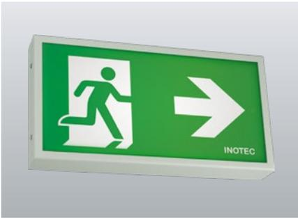
Einseitige Rettungszeichenleuchten mit ballwurfsicherem und schlagfestem Gehäuse aus pulverbeschichtetem Metall. Homogene Piktogramm-ausleuchtung durch optimierte LED-Technik mit einer Leuchtdichte > 500 cd/m<sup>2</sup>. Leuchten in flacher Bauform zum Einsatz in Umgebungen mit erhöhten mechanischen Beanspruchungen und in Sportstätten.
