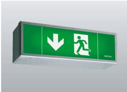
Einseitige Rettungszeichenleuchten aus robustem, gebürstetem Edelstahl mit hoher Schutzart. Homogene Piktogrammausleuchtung durch optimierte LED-Technik mit einer Leuchtdichte > 500 cd/m<sup>2</sup>. Zum Einsatz in Lebensmittelbereichen bzw. lebensmittelverarbeitenden Betrieben mit hohen Anforderungen an Produkthygiene geeignet.
