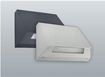
Sicherheitsleuchte mit gerichtetem Licht ohne Lichtstromanteil im oberen Halbraum. Robustes trapezförmiges Leuchtengehäuse für Wandmontage aus pulverbeschichtetem Aluminiumdruckguss. Hohe Schutzart zur Montage im Außenbereich. Und optionaler seitlicher Kabeleinführung.
