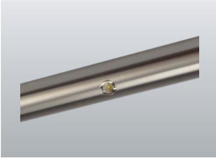
LED-Sicherheitsleuchte zum Einbau in metallische Handläufe z.B. aus Edelstahl oder Aluminium mit einem rundem Querschnitt von 38-52mm und einer Rohrwandstärke  $\geq 1,5\text{mm}$ . Vernickeltes Messing-Gehäuse mit hoher Schutzart IP66. Einfache Montage in einer M18x1 Gewindebohrung. Leuchten zum Anschluss an externen INOTEC LED-Treiber (230V oder 24V).
