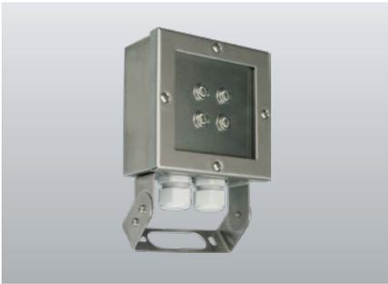
Robuste LED-Sicherheitsleuchten zur Ausleuchtung von Flächen und Rettungswegen mit Lichtpunkthöhen bis zu 32m. Arretierbarer Befestigungsbügel zur Ausrichtung der Leuchten auf den zu beleuchtenden Bereich. Leuchten aus gebürstetem Edelstahl mit hoher Schutzart. Zum Einsatz in Lebensmittelbereichen bzw. lebensmittelverarbeitenden Betrieben mit hohen Anforderungen an Produkthygiene geeignet.
