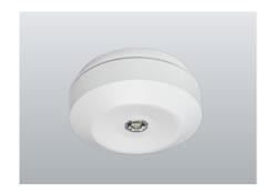
LED-Sicherheitsleuchte mit optimierter Lichtverteilung zur Ausleuchtung von kleinen Flächen wie WCs oder elektrische Betriebsräume mit einer Leuchte. Gehäuse aus pulverbeschichtetem Aluminium zur Deckenaufbaumontage mit optionaler seitlicher Kabeleinführung. Inkl. 4-Chip LED-Leuchtmittel für maximale Sicherheit.
