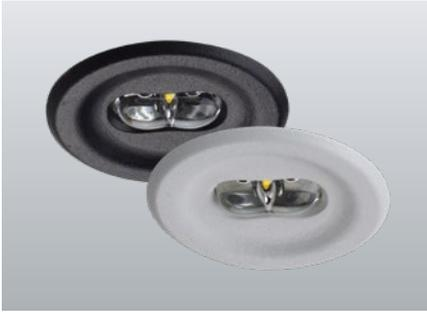
Dezente LED-Sicherheitsleuchte mit optimierter Lichtverteilung zur Ausleuchtung von Rettungswegen. Blende aus pulverbeschichtetem Aluminium mit einem Durchmesser bzw. Kantenlänge von lediglich 45mm. Leuchte inkl. Treiber zum Einbau in Ø 38mm Deckenausschnitt.
