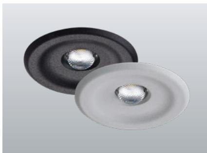
Dezente LED-Sicherheitsleuchte mit optimierter Lichtverteilung zur Ausleuchtung von hervorzuhebenden Stellen mit 5lx vertikaler Beleuchtungsstärke. Blende aus pulverbeschichtetem Aluminium mit einem Durchmesser bzw. Kantenlänge von lediglich 45mm. Leuchte inkl. Treiber zum Einbau in Ø 38mm Deckenausschnitt.
